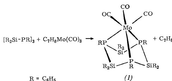
Leuchtend gelbe Kristalle von (I) entstehen mit 52% Ausbeute; sie sind in Tetrahydrofuran und heißem Benzol gut löslich, luftempfindlich und zersetzen sich oberhalb 165 °C langsam unter Schwarzfärbung. Das IR-Spektrum<sup>[4]</sup> zeigt zwei scharfe νCO-Banden bei 1931 und 1838 cm<sup>-1</sup> sowie drei
